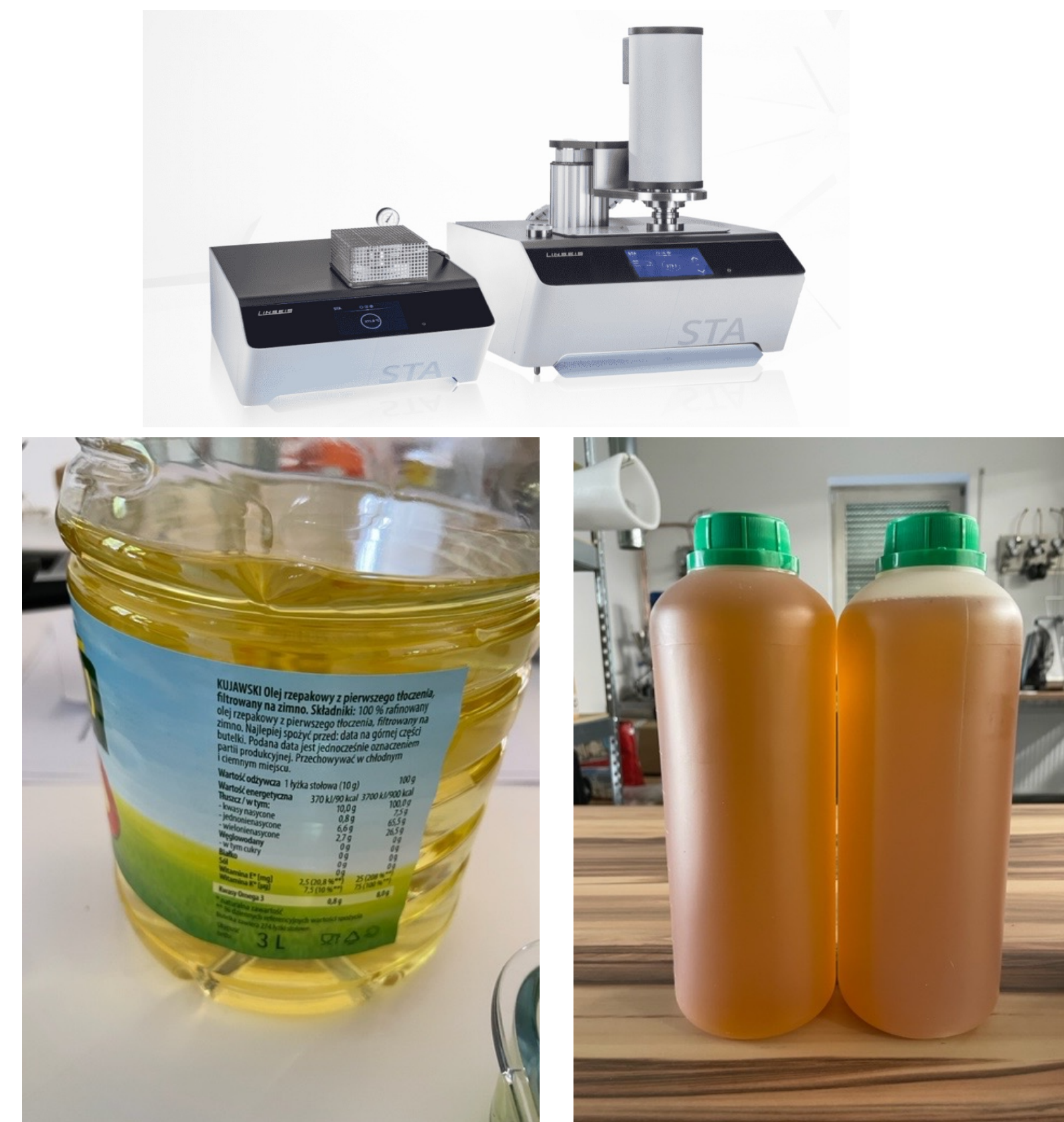
Rys. 3. Aparatura do analiz próbek z wybranych etapów transestryfikacji analiza termiczna STA – kalorymetr DSC z termogravimetrią TGA na górze; oleje poddane transestryfikacji - na dole.
