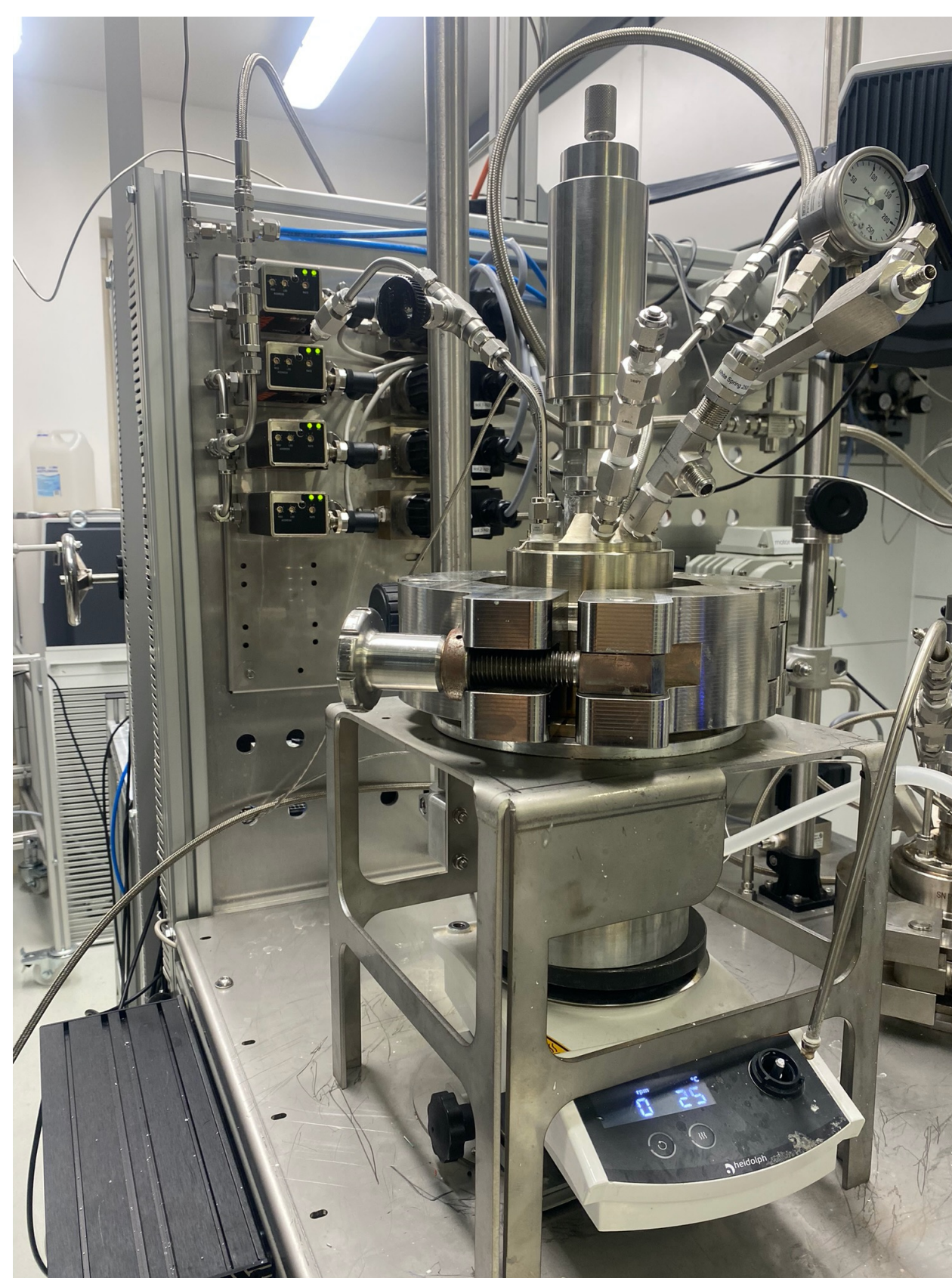
Rys. 2. Reaktory ciśnieniowe z oprzyrządowaniem dozującym MFC, pompami cieczowymi i układem analitycznym Macierz9.
